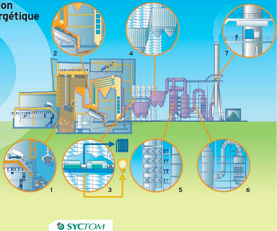
Illustration 12: Fonctionnement de l'incinérateur d'Ivry-Paris XIII (source: Sycotom)
